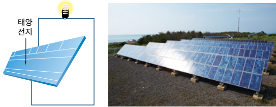
태양 전지: 태양빛을 받아 빛에너지를 전기 에너지로 전환해준다.
