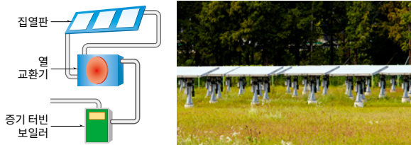
태양열 발전: 증기를 만들기 위한 충분한 열에너지를 얻기 위해서 거울(집열판)을 이용해 태양열을 한 곳으로 모은다.
