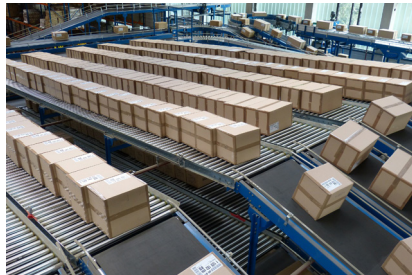
컨베이어 벨트: 소품종 대량 생산은 위와 같이 컨베이어 벨트에 같은 물건을 대량으로 만들어내는 방식으로 생산된다.
